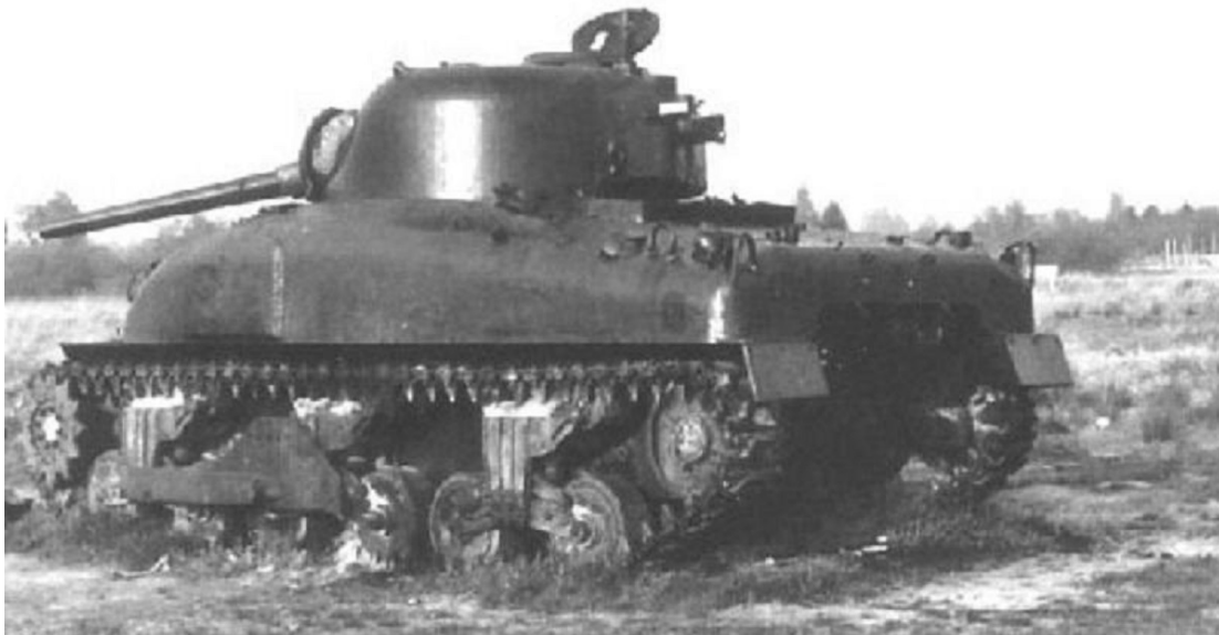
Sherman TD (Tank Dozer) M 4 «cible» à caisse moulée atteint par les tirs de 73 mm Mle 50 d'exercice dont on remarque les restes de talc sur le train de roulement.
